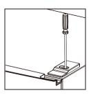
7. Снимите верхнюю дверцу, крестовой отверткой выньте винт из средней петли, затем снимите нижнюю дверцу.
